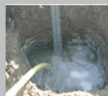
Figur 12. Vandmætningen fortsættes, indtil vandspejlet synker med konstant hastighed. I praksis foregår dette ved at måle synkehastigheden med 30 minutters mellemrum.
