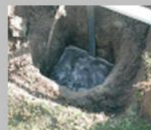
Figur 11. Hullet holdes fyldt i cirka 30 minutter – i våde perioder (med megen nedbør) dog kun 15 minutter.
