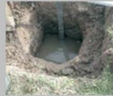
Figur 16. Undersøgelsen afsluttes med at omregne måleresultaterne til meter/sekund og tildække hullet.
